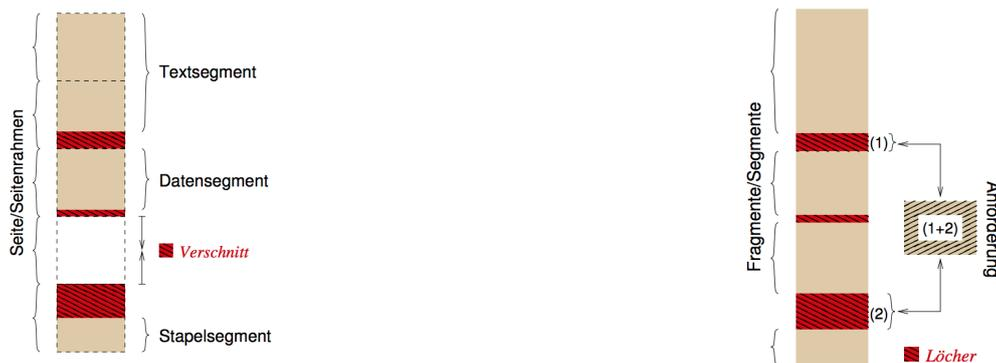
(a) Schaubild für den internen Verschnitt (rot dargestellt) (b) Schaubild für den externen Verschnitt (Löcher)
