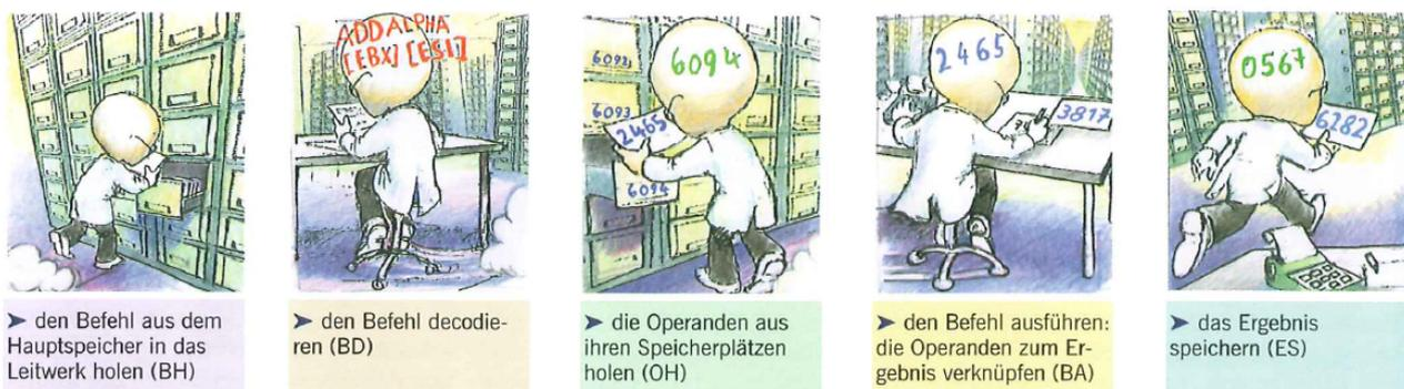
Abbildung 4.1: Befehlsabarbeitung ohne Pipelining
