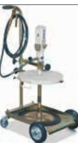
Pompă manuală mobilă pentru butoi 20 kg 60 kg 50: 1 unsoare pompa 480mm, pistol de unsoare, cu Z-pivotantă și furtun 2m
