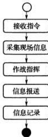
图 5.3.1 现场指挥子系统基本工作流程
