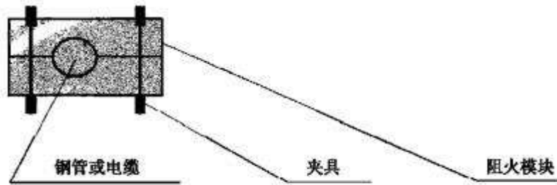
图 1 防火模块的腐蚀性试验
