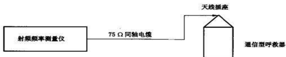
图 1 发射频率、频率稳定度测量图
