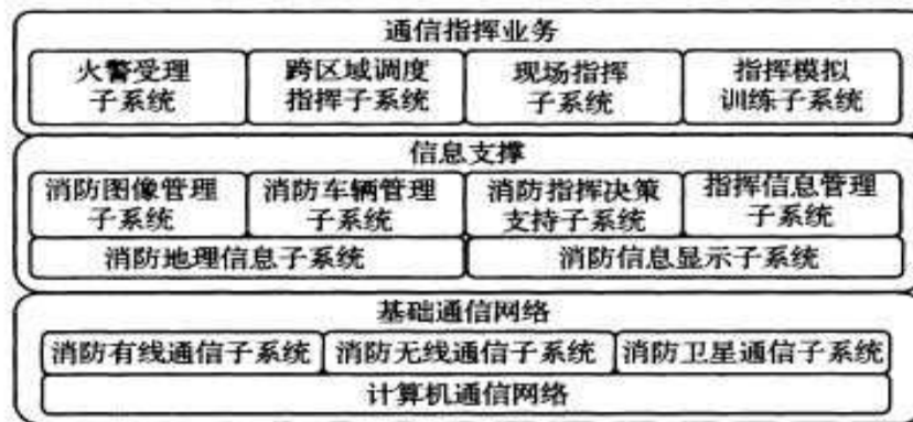
图 3.0.2 消防通信指挥系统的技术构成
