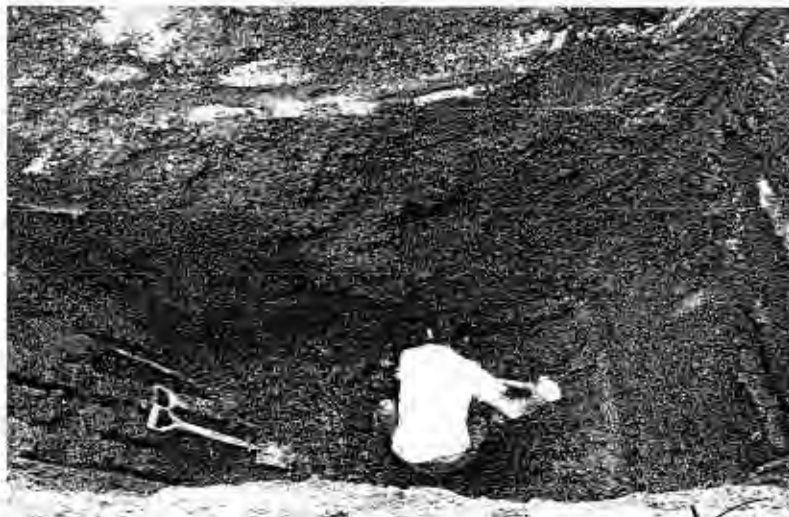
CULMINACIÓN DE EXCAVACIÓN DE PCA-3 EN LA ZONA DE ESTUDIO Y LOCALIZACIÓN DE TERRENO DE DESPLANTE
