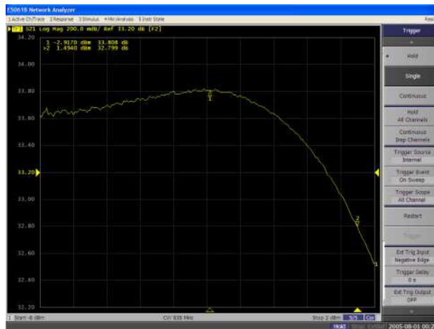
Figura 0.2: Curvas AM-AM de la placa de evaluación adaptada en los límites (arriba) y centro (abajo) de la banda de frecuencias de trabajo.
