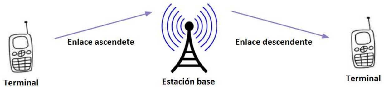
Figura 0.1: Radioenlace de telecomunicaciones.
