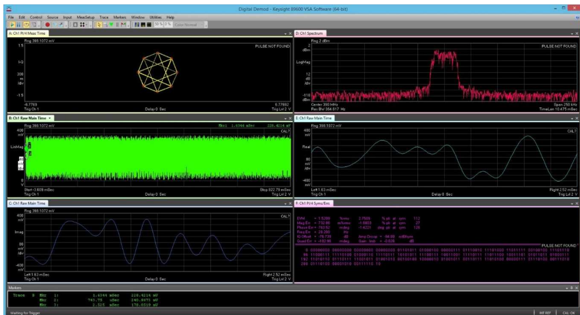
Figura 7.1: Señal de entrada del amplificador de potencia de la infraestructura TETRA.
