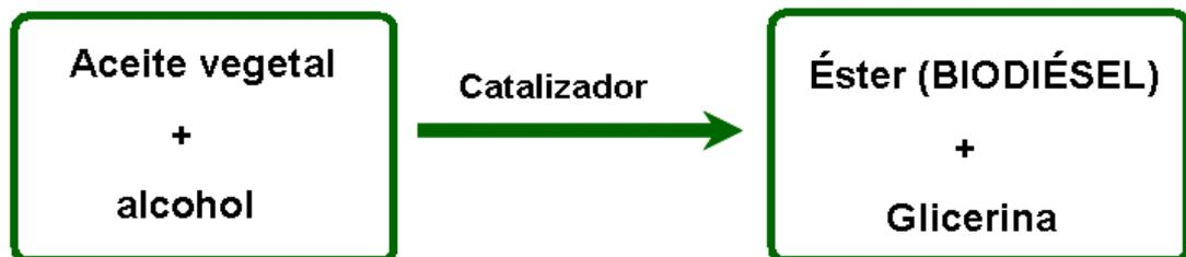
**Figura 4:** Proceso simple de producción de biodiésel
