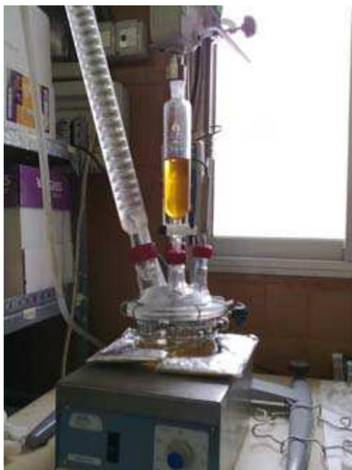
**Figura 8:** Planta para la producción de biodiésel utilizada en la experimentación
