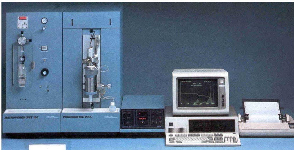
Figura 12. Equipo porosimétrico formado por la unidad "Macropore 120" (izquierda) para la determinación de la macroporosidad, la unidad "Porosimeter 2000 WS" y su módulo de registro (centro) para la microporosidad y un ordenador para el tratamiento y presentación de los datos suministrados por ambas unidades.
