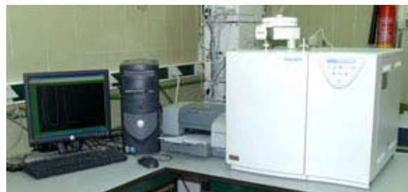
Figura 3. Analizador Carlo Erba 1108 y un analizador Termo Flash 1112 para la determinación de (C, H, N, S y O) con un rango de detección desde 0,05% hasta 99,95%.
