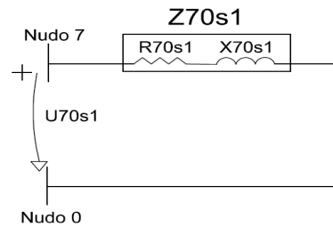
Figura 3.15: Modelo de línea corta para secuencia directa Z_{70s0}=Z_{70s1}=Z_{70s2}
