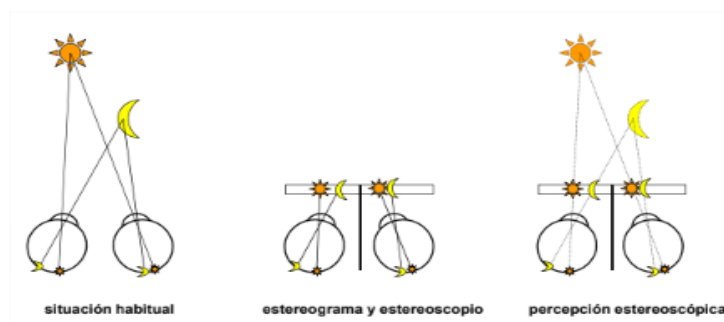
Figura 9: Principio de funcionamiento de un estereograma [4]
