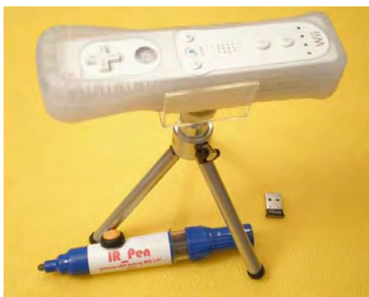
Слика 8. Систем Wiimote WhiteboardWiimote Whiteboard
