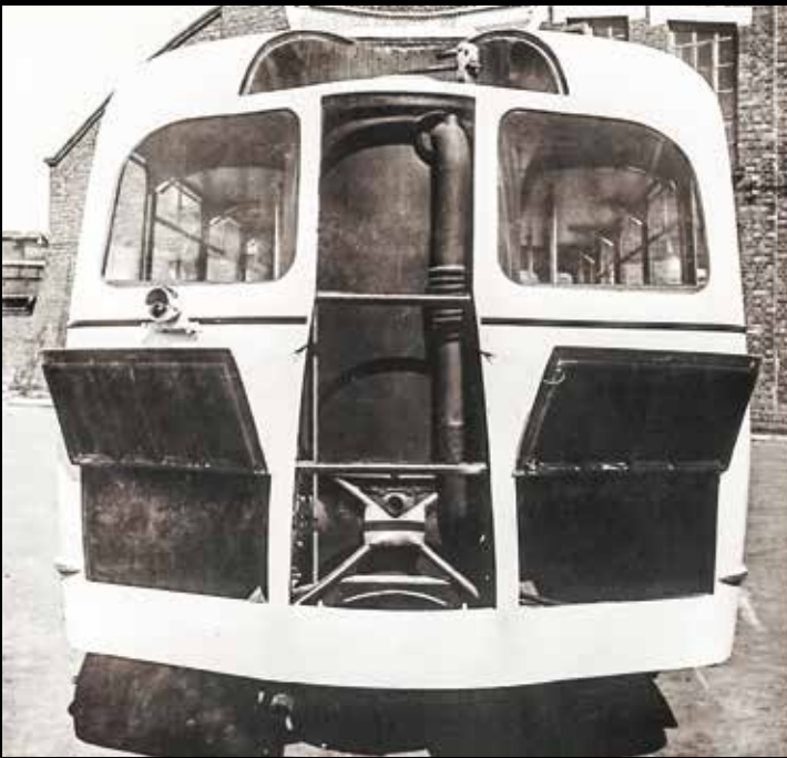
Tył autobusu PZInż. 723 G. Centralnie: gazogenerator (zdjęta ażurowa osłona wkomponowana w obłachowanie nadwozia), po bokach otwarte ładownice paliwowe na zapas drewna do gazogeneratorsa. Zdjęcie na podwórzu fabryki.
