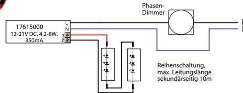
**LED-Konverter Konstantstrom 350mA, dimmbar**
