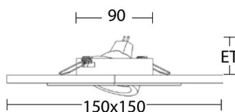
**Einbaustrahler mit Radial-LED-Kranz
