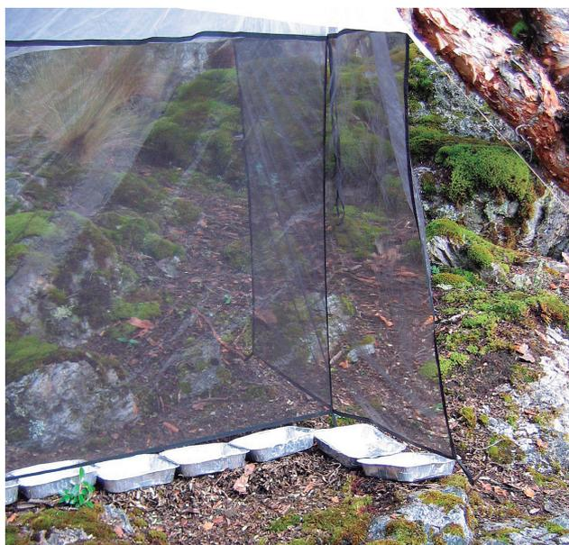
Figura 14. Bandejas con solución colectora.
