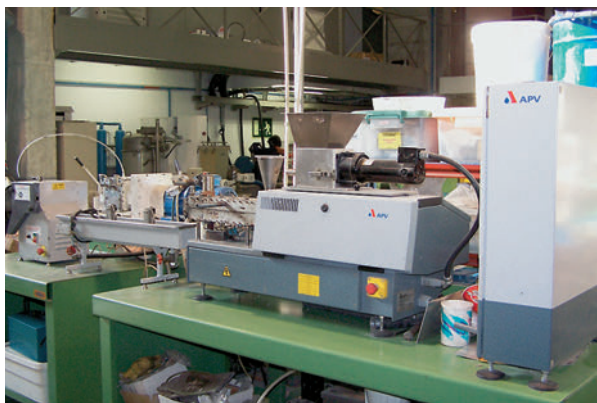
Birziklatutako karbono-zuntza polipropilenoarekin edo poliamidarekin konbinatzen da makina honetan.
