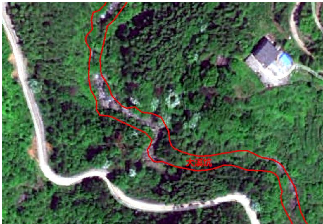
山区性河道管理范围线与临水线重合 (图中示例为山区性河道大溪坑，临水线与管理范围线重合，为红色所示)
