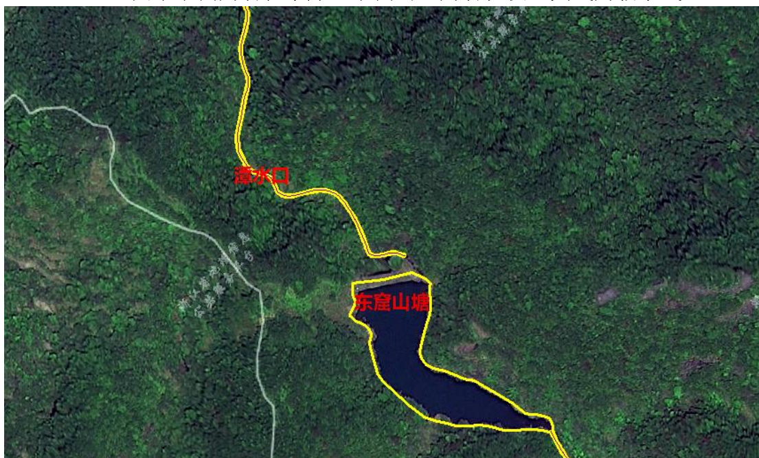
以山塘溢洪道末端作为河道起点的示例 (图中示例山塘为东窟山塘, 示例河道为潭水口, 黄线为水域临水线)
