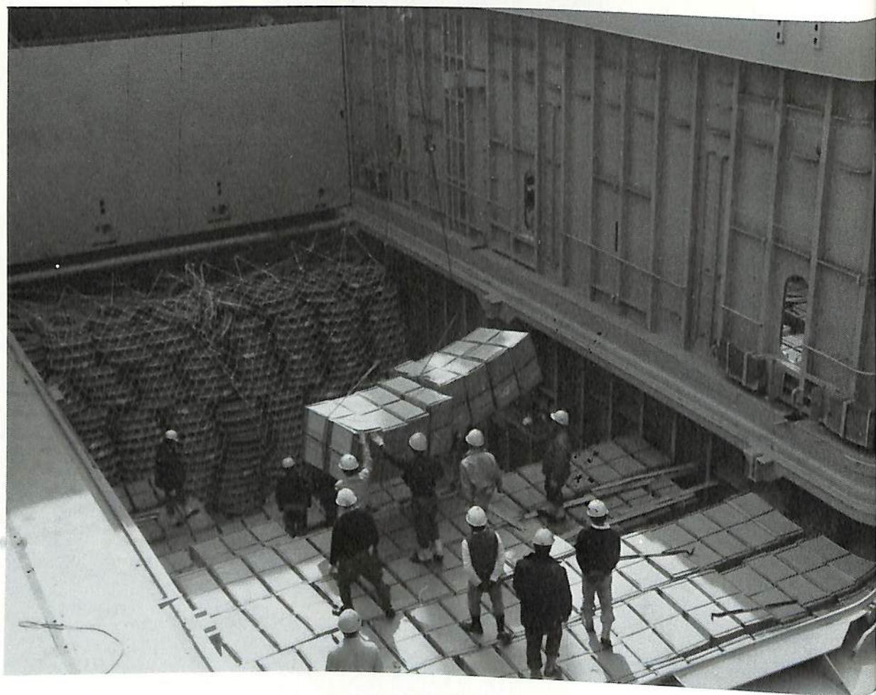
ハウス前のコンテナ搭載場所。20ft.コンテナ が2段7列積載可能
