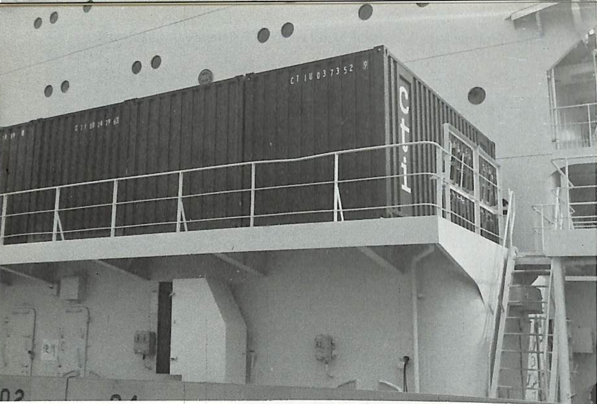
ハウス前のコンテナ搭載場所。20ft.コンテナ が2段7列積載可能
