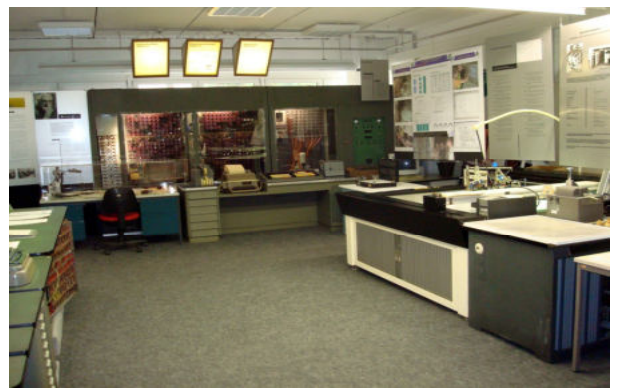
Zuse-Abteilung (links: Relaisrechner Z11, rechts: Röhrenrechner Z 22R und Graphomat Z 64)
