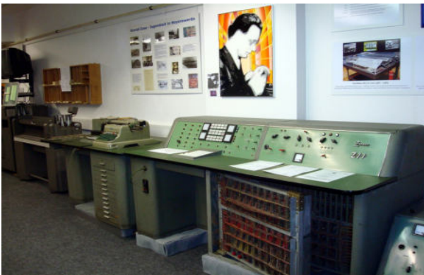
Zuse-Abteilung (links: Relaisrechner Z11, rechts: Röhrenrechner Z 22R und Graphomat Z 64)
