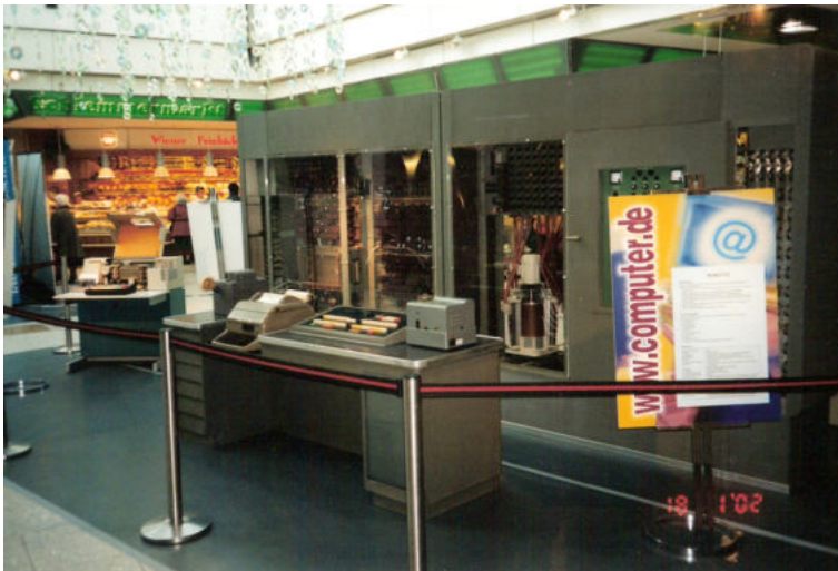
Z22R, eine Weiterentwicklung des ersten industriell gefertigte Röhrenrechners der Fa. Zuse KG - Baujahr ab 1958
