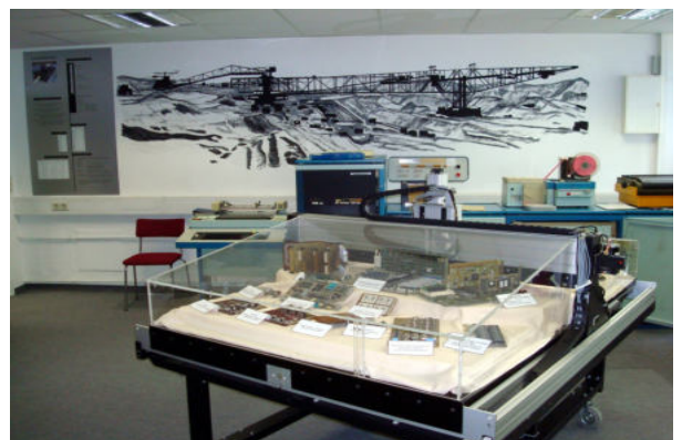
KRS 4201 von Robotron (Hintergrund) für Aufgaben der Überwachung, Steuerung und Abrechnung einer Tagebau-Förderbrücke
