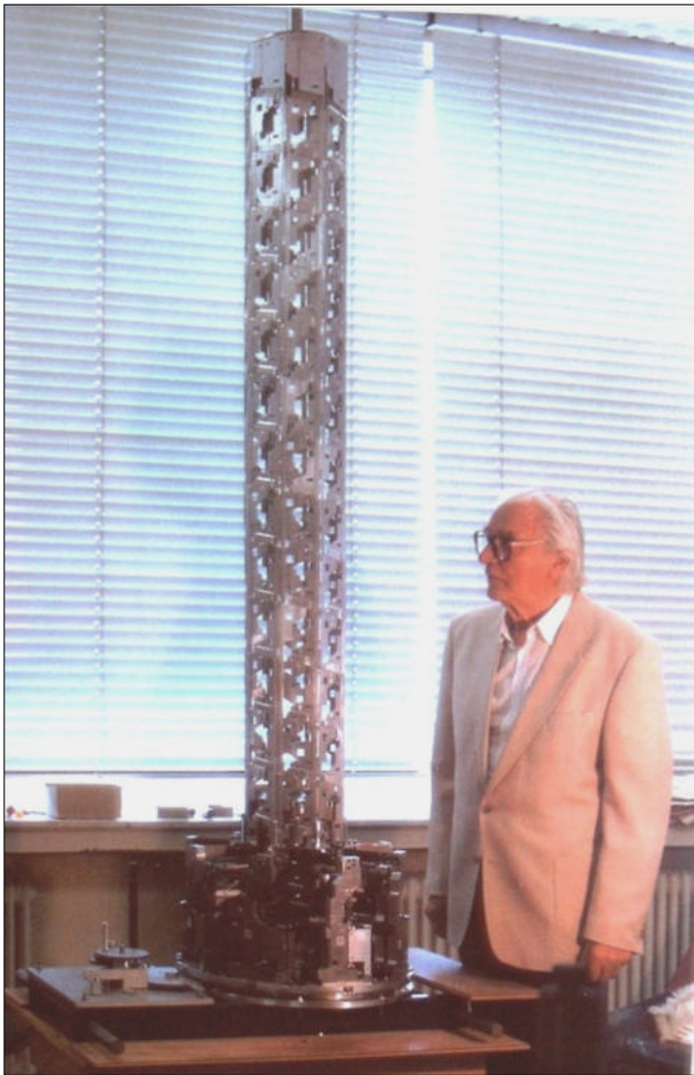
Zuse mit dem funktionsfähigen Modells seines Helix-Turms. Links unten die Handkurbel, mit welcher der Turm ein- und ausgefahren werden kann.
