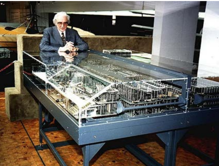
Abb. 8: Nachbau der Z1 im Deutschen Technikmuseum Berlin, Bauzeit 1987-1989. Der Nachbau umfasst ca. 30000 Einzelteile, wie Bleche, Stifte, Federn, Schrauben.
