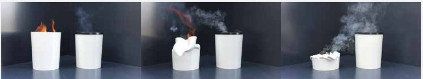
Sicherheitspapierkorb vs. Sicherheitspapierkorb mit Löschkopf - safety waste bin vs. safety waste bin with flame retardant top
