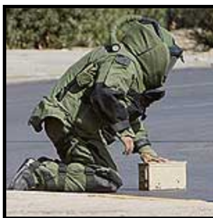
Figura 3.2-1 – Roupa especial de proteção para manuseio de explosivos
