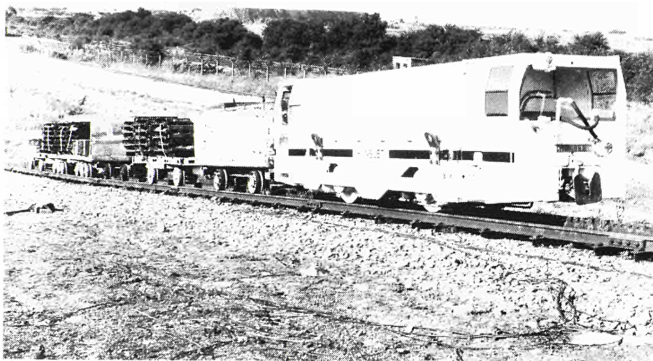
Abbildung 1: Hunslet-112-kW-Lokomotive mit Zahnrad-Reibantrieb
