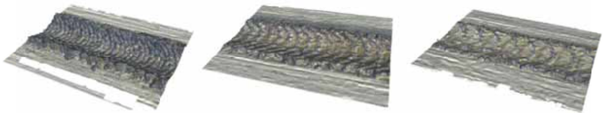
Obrázek 3 Rozdílná interakce laserového paprsku s materiálem při změně skenovací rychlosti
