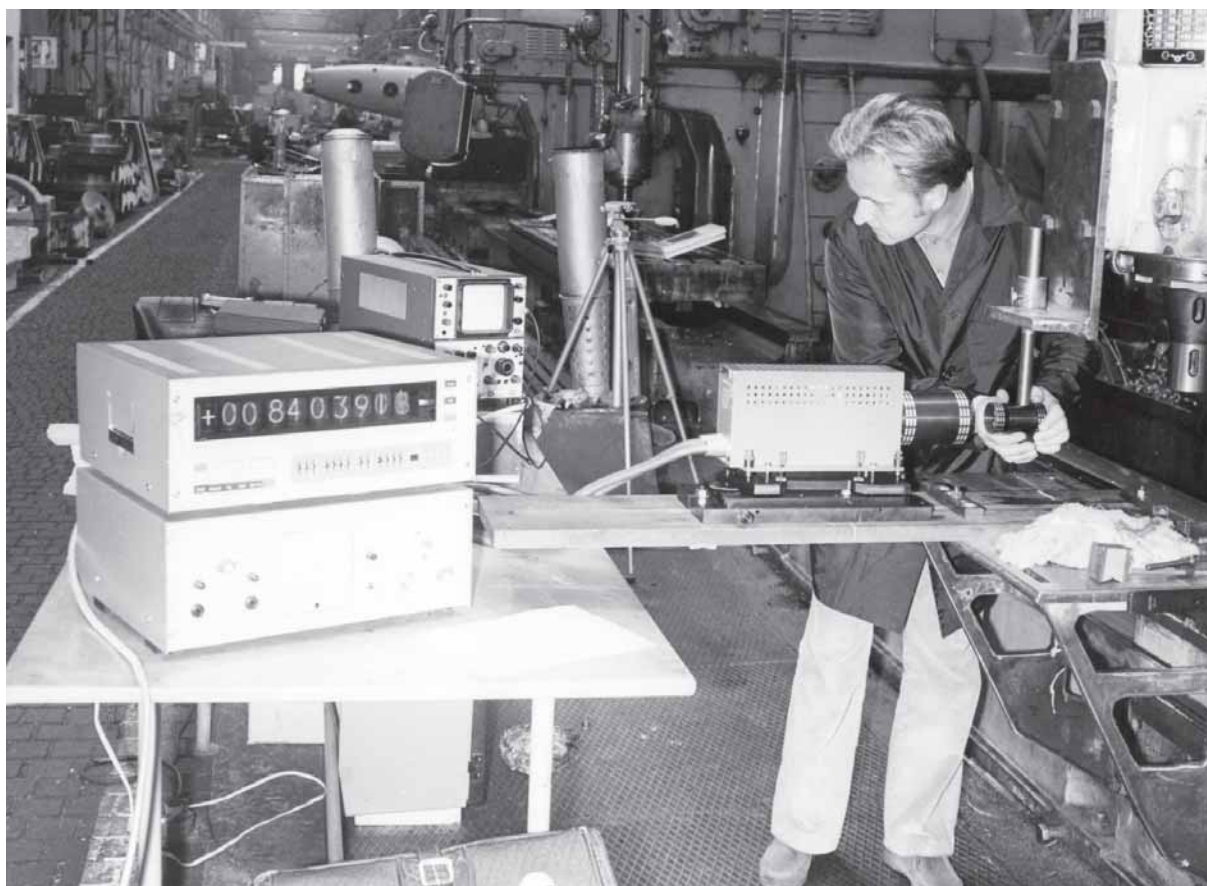
Obr. 5: Použití laserového měřiče délky ve Vítkovcích na frézce. Laserová hlavice je pevně spojená s dělicí optikou, měřící svazek se šířil ke koutovému odražeči, který byl připevněn k odměřovanému vzorku. Tento výrobek byl v roce 1971 oceněn zlatou medailí na Mezinárodním strojírenském veletrhu v Brně.
