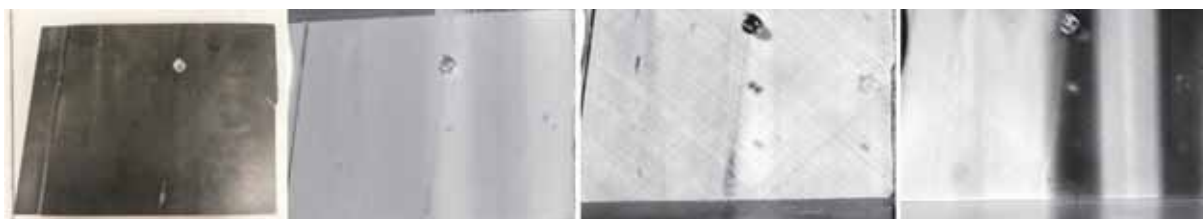
Ukázka detekce anomálií CFRP po externí excitaci
