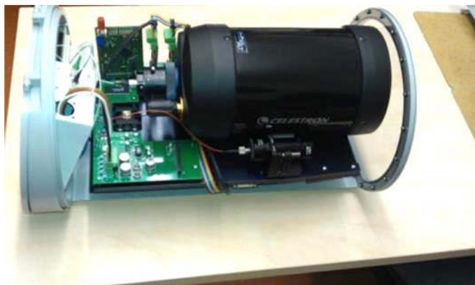
Vnitřní uspořádání jednotky FSO-ODU.
