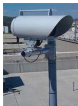
Instalace FSO-ODU na střeše budovy FEKT
