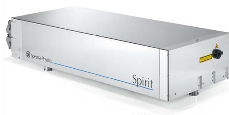
Obrázek 1 Laser SPIRIT má průměrný výkon > 16 \text{ W} na 1040 \text{ nm} nebo > 8 \text{ W} na 520 \text{ nm} při délce pulsu < 400 \text{ fs} . Opakovací frekvence je nastavitelná od jednotlivých pulsů do 1 \text{ MHz} . Napravo je vzorek skla řezaný metodou ClearShape™.
