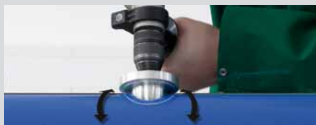
Remover la barrera de oxígeno en la tubería aquatherm blue pipe OT
