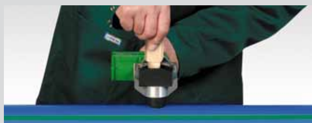
La matriz del soldador es insertada dentro del tubo ...
