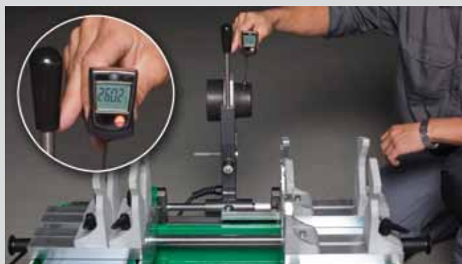
Medición de la temperatura en equipo de soldadura
