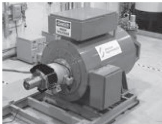
Σχήμα 2.20: Τετραπολικός κινητήρας ισχύος 5000HP με υπεραγώγιμα τυλίγματα, κατασκευής AMSC.
