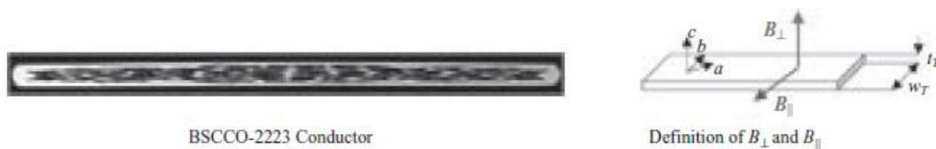
Σχήμα 2.4: Υπεραγωγίμη ταινία κατασκευασμένη από BSCCO-2223.
