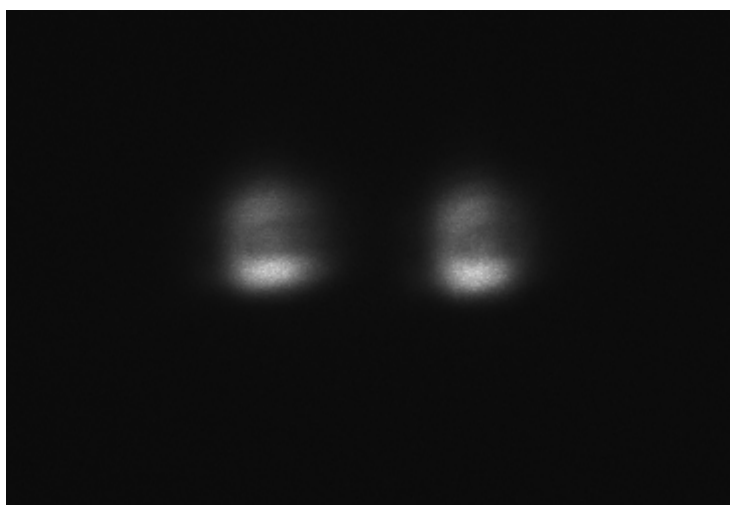
Εικόνα 6.2: Απεικόνιση δύο διαδοχικών spot κατά τον x άξονα, με απόσταση του συστήματος από την επιφάνεια προβολής 1.52m.
