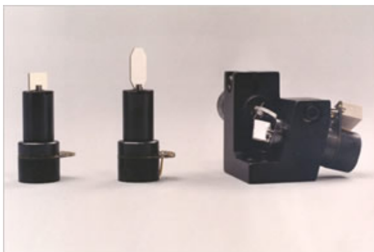
Εικόνα 5.2: Απεικόνιση του ζεύγους των γαλβανικών καθρεφτών που χρησιμοποιήθηκαν.
