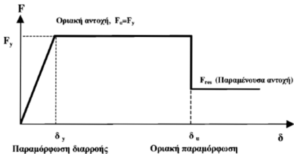
Σχήμα 2.3. Πολυγραμμικό διάγραμμα προσεγγιστικής περιγραφής της συμπεριφοράς δομικού στοιχείου, κρίσιμης περιοχής ή κόμβου (ΚΑΝ.ΕΠΕ.).
