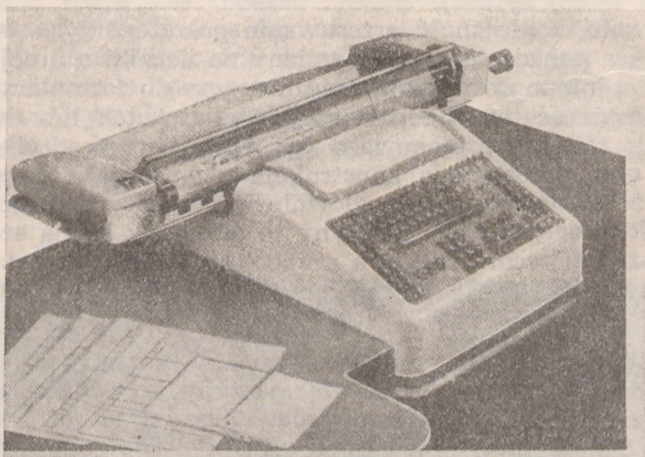
Maszyna do księgowania konstrukcyjnie oparta na maszynie do dodawania - klawiatura uproszczona (Ascota kl. 170)
