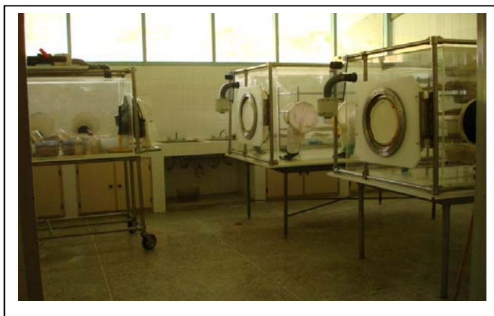
Figura 4. Aisladores usados para la producción del núcleo de fundación de los ratones de la cepa BALB/c//BIOULA .
