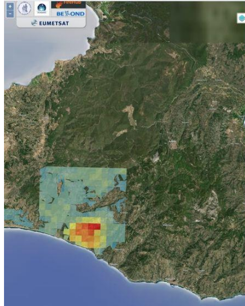
Εικόνα 15: Ανίχνευση έναρξης πυρκαγιάς στα Βατερά, Λέσβου από το σύστημα FireHUB
