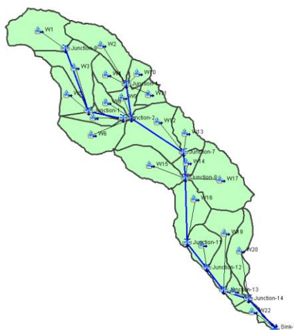
Εικόνα 53: Σχηματικό μοντέλο βροχής απορροής.
