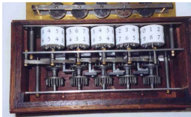
Figura 3 Detalle del interior de la Pascalina (3)
