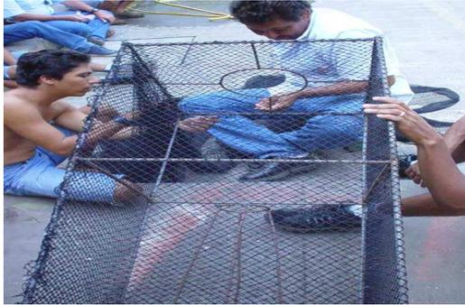
**Figura. No. 3.** Elaboración de nasa y colocación de malla de ceda al esqueleto de hierro por los trabajadores del pañol de buceo de la Empresa Portuaria Quetzal.
