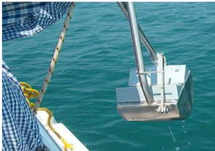
**Figura. No. 5.** Draga para la extracción de las muestras de fondos
