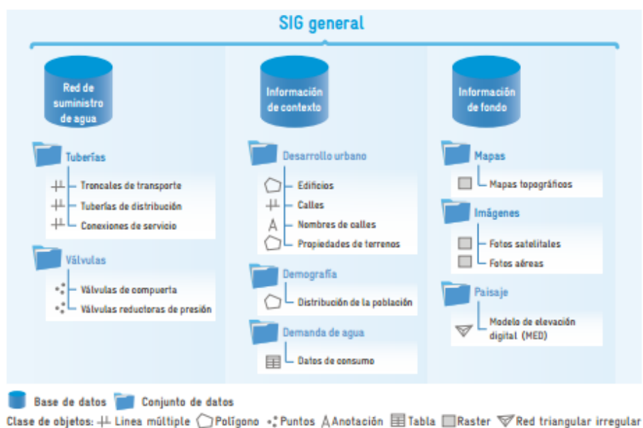
Figura 7.1: Estructura de un GIS con sus bases de datos
