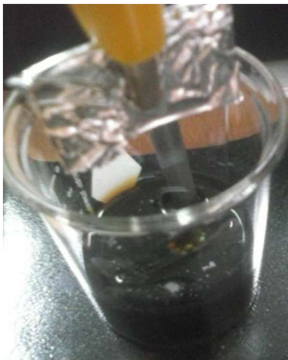
Imagen 7. Celda para la electrodeposición del PB.
