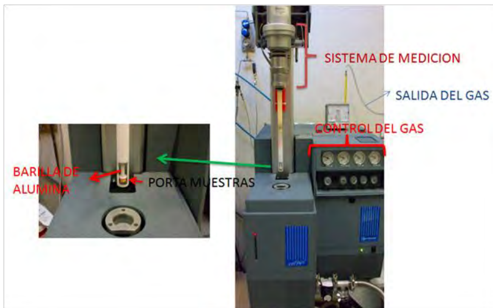
Figura 2.5 Diagrama esquemático del equipo dilatómetro vertical.
