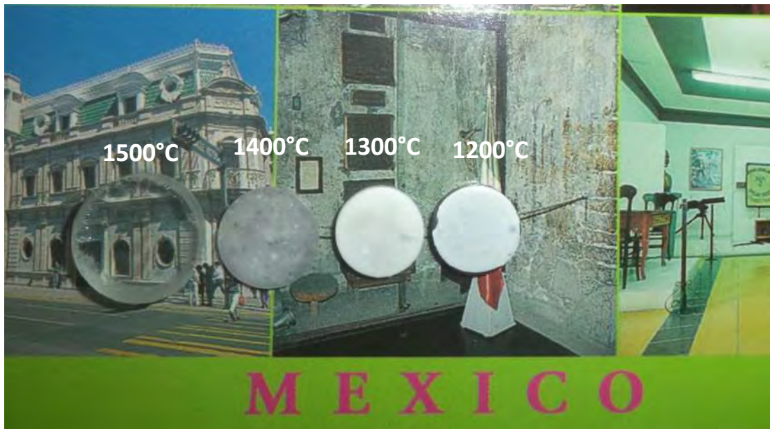
Figura 3.66 Alúminas transparentes de los conformados por PI calentado por SPS a las diferentes temperaturas de sinterización.
