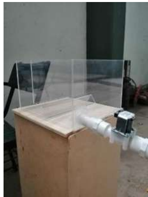
Figura 13. Tanque de separación de grasa y aceites
