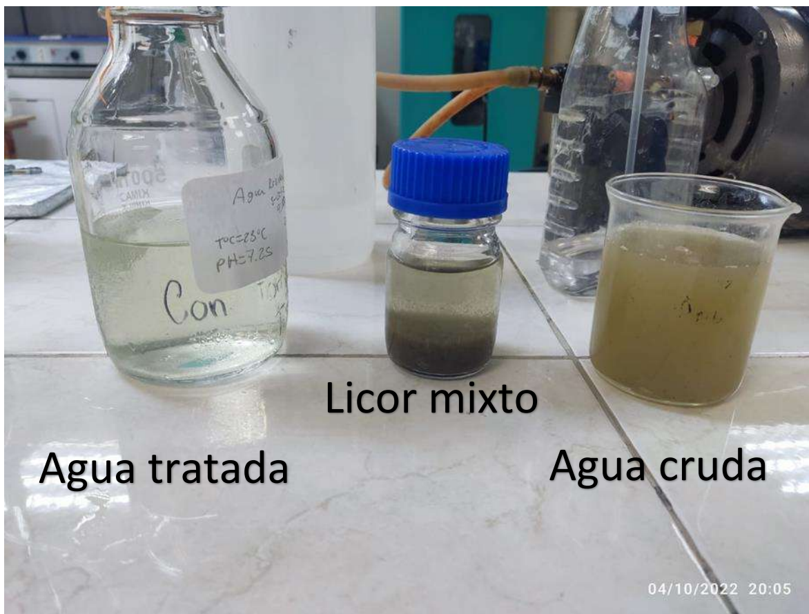
Figura 35. Muestras de agua residual cruda, tratada y lodo del proceso de clarificación (fuente propia)
