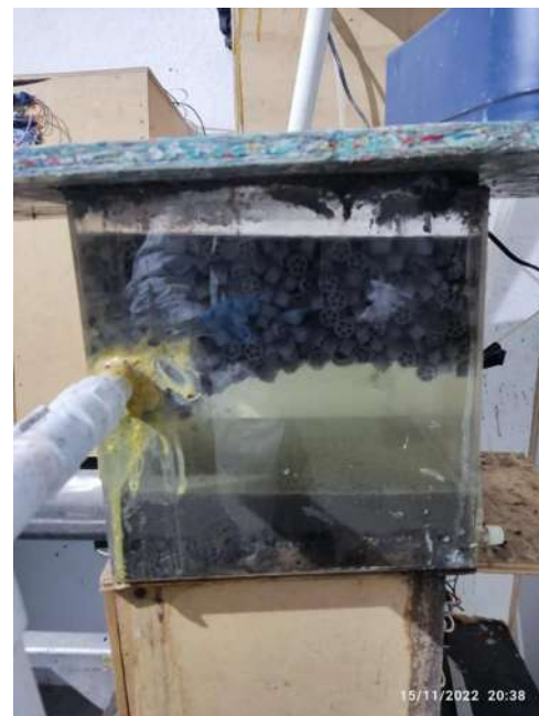
Figura 43. Comportamiento del lodo dentro del reactor en reposo
