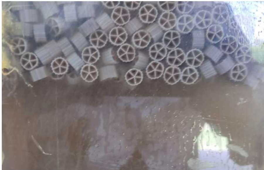
Figura 41. soportes "K1" con crecimiento de biofilm
