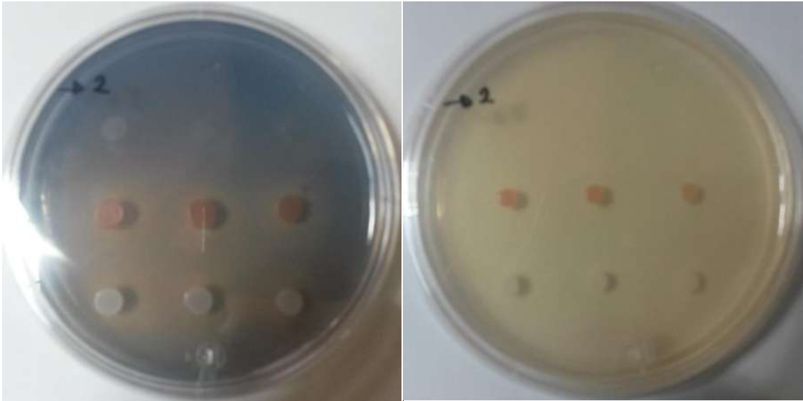
Figura 45. Determinación cualitativa de actividad lipásica de 3 cepas pertenecientes al cepario del Laboratorio de Bioquímica del Instituto Tecnológico de Morelia. Medio Spirit Blue después de incubación a diferentes tiempos: 24 horas (izquierda) y 48 horas (derecha). Fila superior: S. cerevisiae W303; fila central: Y. lipolytica E129; fila inferior: K. marxianus ITMLB03.
