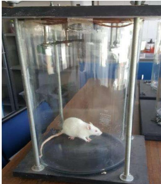
**Figura 11.** Cámara de exposición estática. Posee una jarra cromatográfica con tapa de acrílico. La tapa tiene puertos de inyección y se conecta, en su parte externa al motor de un ventilador cuyas aspas proyectan hacia el interior de la cámara. Bajo las aspas hay una malla metálica donde se coloca un papel filtro para administrar allí el disolvente.
