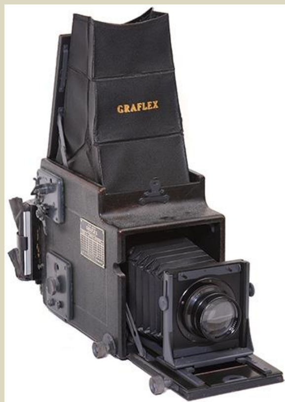
Jednooký zrcadlový přístroj Graflex na plochý film a desky většího formátu
