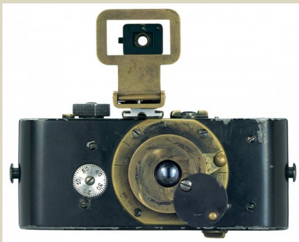
Ur-Leica, prvotní konstrukce přístroje na kinofilm 35 mm z roku 1914
