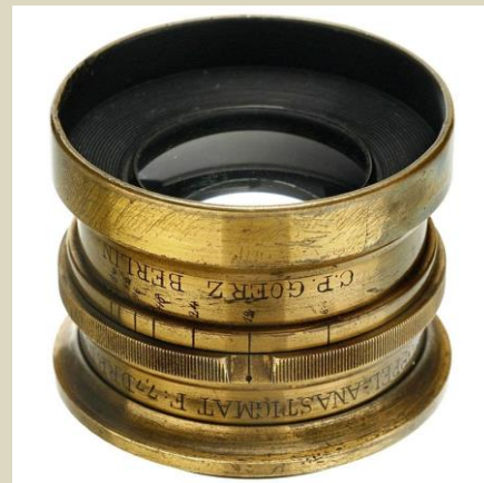
Dvojitý anastigmat (f/7,7) firmy Goertz, c. 1893
