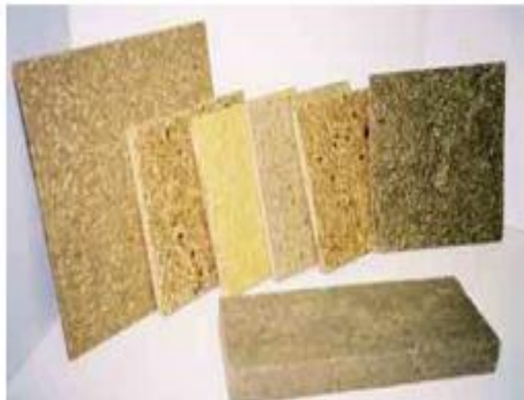
Resim 2.2. Kenaf hammaddeli yalıtım malzemesi ve tavan paneli
