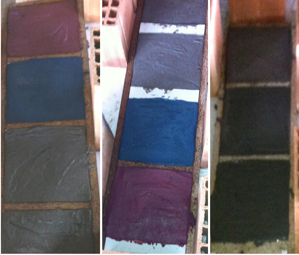
Resim 3.13. Pirinç kabuğu külü içeren karma numuneler
