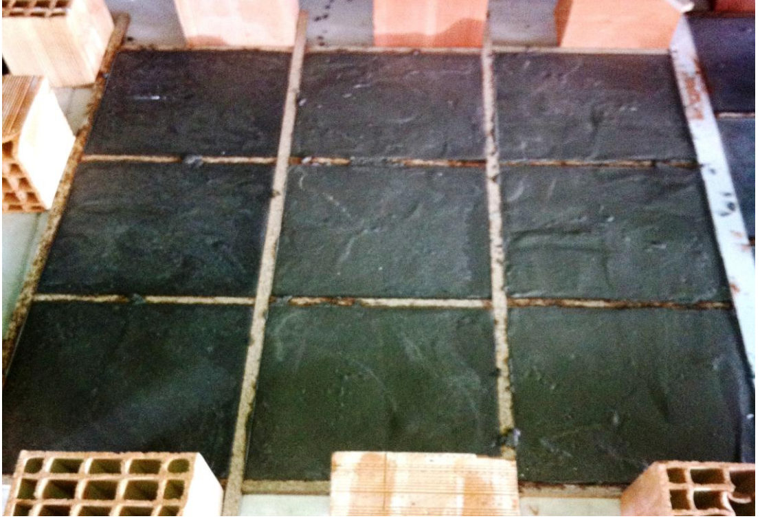
Resim 3.11. %20, 25 ve 30 oranında pirinç kabuğu külü içeren numuneler
