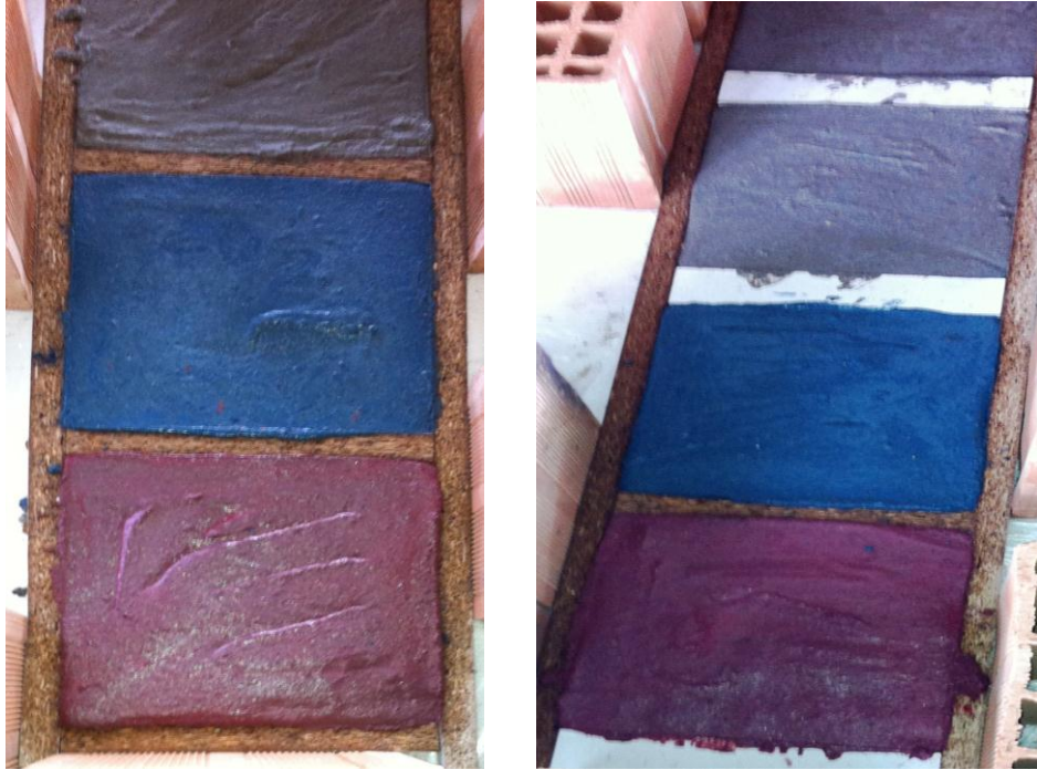
Resim 3.12. %15 ve 20 oranında pirinç kabuğu külü içeren renkli ve normal numuneler
