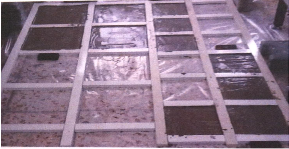
Resim 3.4. Katkısız (referans) ve %10 pirinç kabuğu külü, %2 atık kağıt lifi içeren Numuneler
