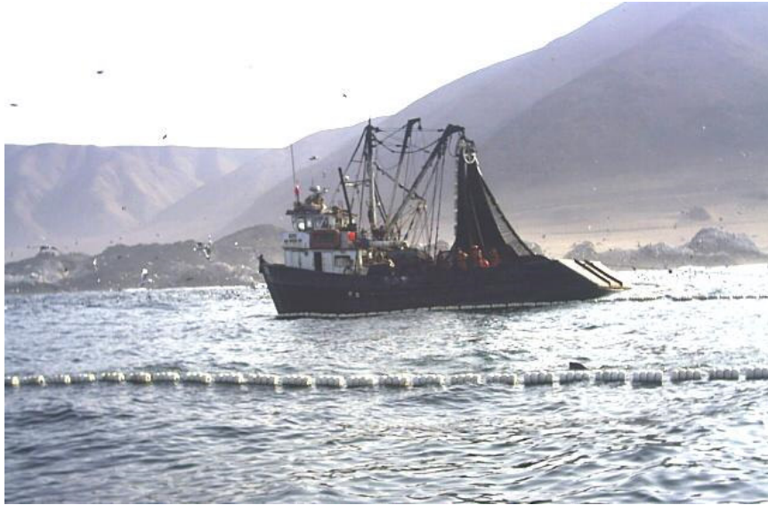
Fig. 2. Embarcación con la red de cerco lanzada para la captura de anchoveta (tomado de FAO, 1994)
