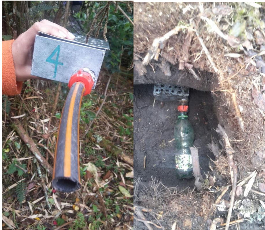
Fotografía 20. Instalación de pluviómetros y lisímetros Eco barrio Villa Rosita Fuente: Equipo Ecobarrios
