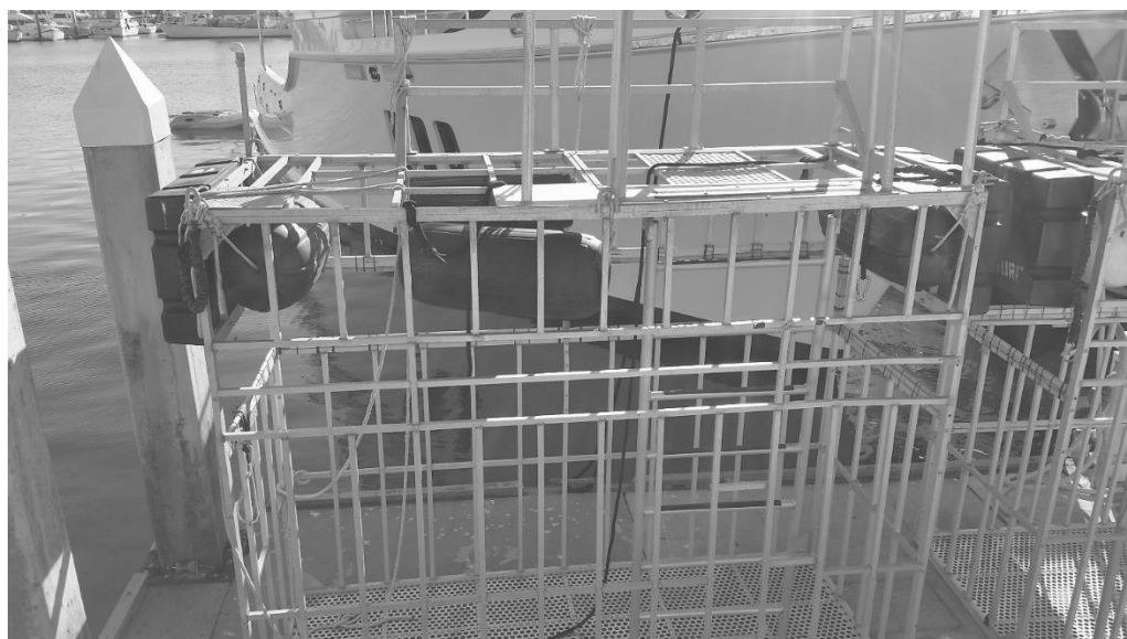
Figura 9. Sistema de flotación de emergencia (en negro).
