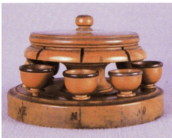
Figura 2: Sismoscopio construido en 1703 por el abate francés, físico e inventor, Jean de Hautefeuille (1647-1724).
