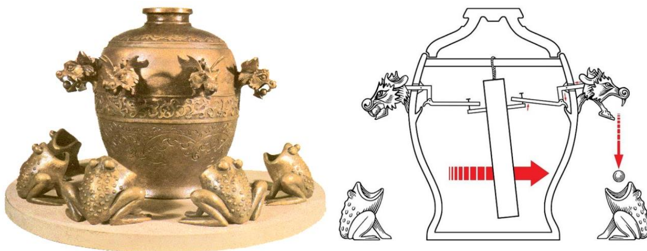
Figura 1: Sismoscopio inventado por el científico chino Hang Chen (Año 132 d.C.).
