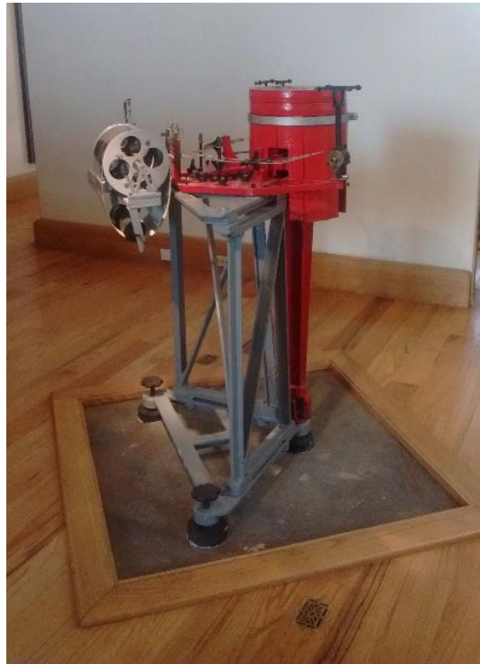
Figura 8: Sismógrafo horizontal Wiechert. Museo de Geofísica (UNAM) – México. Masa del péndulo: 80 kg.
