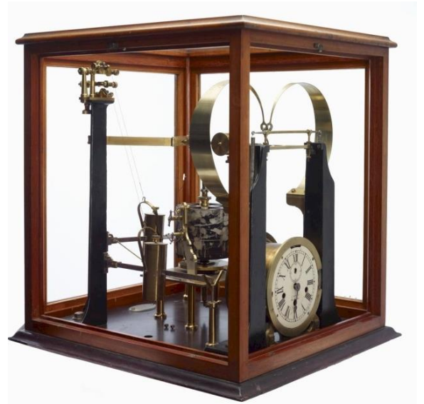
Figura 5: a) Ilustración del sismógrafo Milne publicada en la revista "The Popular Scieny Monthly", Vol XXIX, mayo a octubre 1886. New York. D. Appleton and Company.
