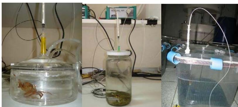
Figura 2. Cámaras respirométricas utilizadas en las mediciones de oxígeno.
