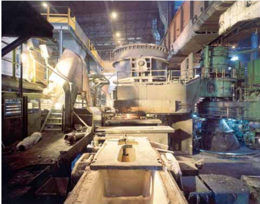
Colata continua: colaggio acciaio in paniera
