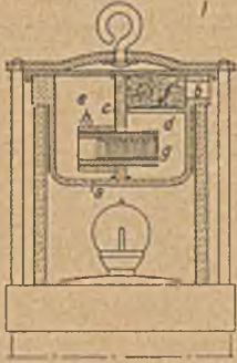
a Glasgefäß mit Öffnungen b , c Scheidewand aus porösem Ton, die a in die Kummern d und e (Diffusionskammer) teilt, f Wattebausch zum Abfangen von Kohlenstaub und Feuchtigkeit, g Blasealgmembran, h Skala.
