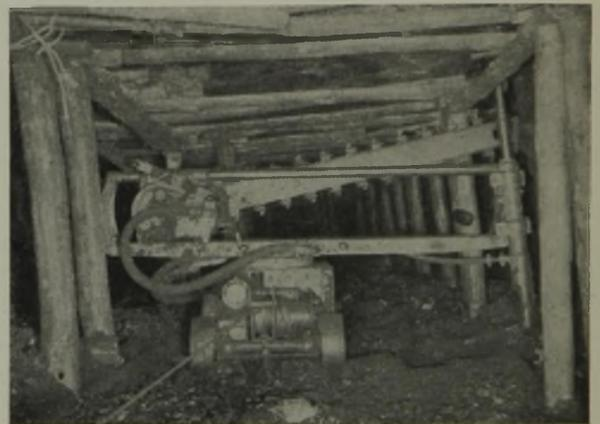
Abb. 4. Einbruchkerbmaschine auf Rädern.
