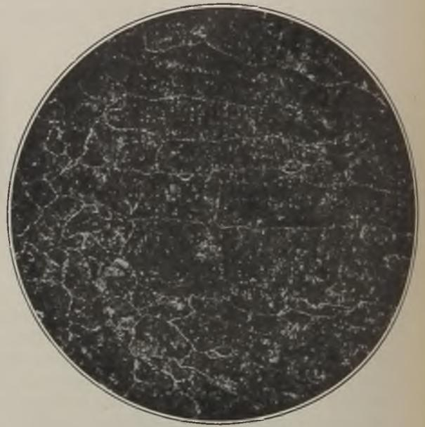
Abb. 141. Kohlenstoffätzung (Stahlguß mit 0,46<sup>0/0</sup> C). Vergr. 5.
