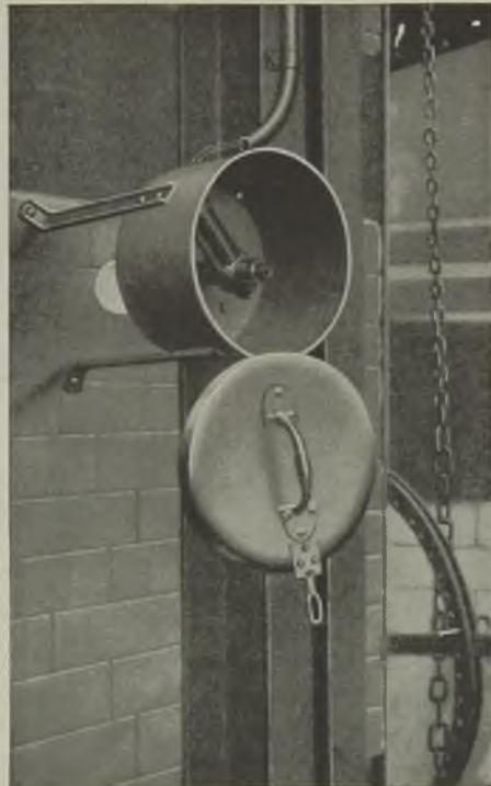
Abb. 265. Anordnung des Pyrometers im Ofenschau Loch.
