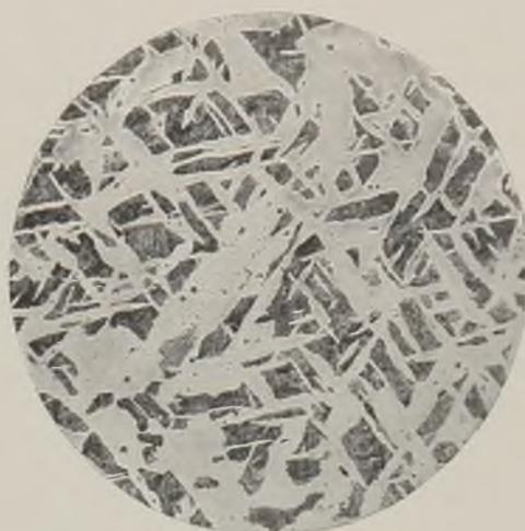
Abb. 219. Stahlguß mit 0,27% C.
