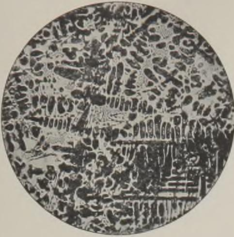
Abb. 78. Temperrohguß. Mischkristalle und Ledeburit. Vergr. 100.
