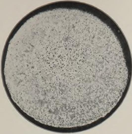
Abb. 101. Geätzter Gesamtquerschnitt durch Tiegeltemperguß.
