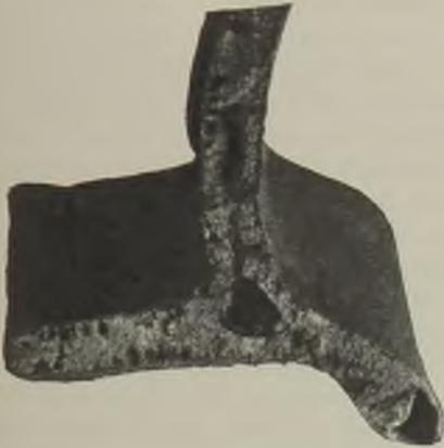
Abb. 149. Teil eines Grubenrads aus Stahlformguß.
