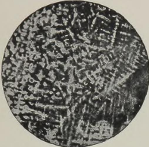
Abb. 132. Schichtkristalle in einer Eisen-Phosphorlegierung mit 0,8% P. Vergr. 4.
