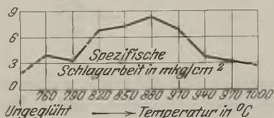
Abb. 225. Durchschnittswerte für Kerbzähigkeit geglühten Stahlgusses.
