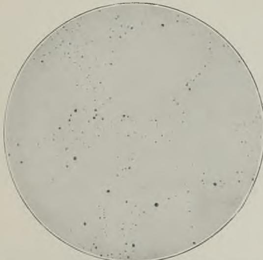
Abb. 145. Elektrolytisen im Sauerstoffstrom geschmolzen, eutektische Anordnung der sauerstoffhaltigen Teilchen, ungeätzt. Vergr. 50.
