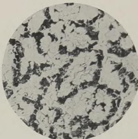
Abb. 221. Stahlguß mit 0,27% C nach Erhitzen auf 850° C.
