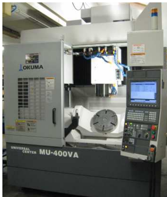
Obr. 15. – Pětiosé obráběcí centrum
